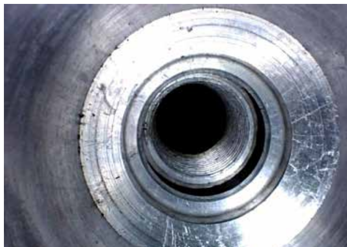
Foto ovan: Inspektion av tändstiftsport
